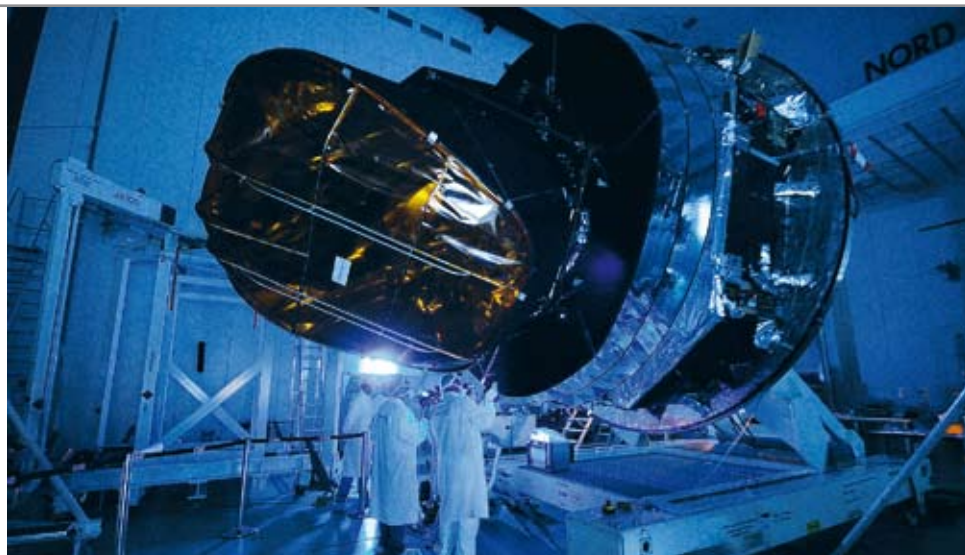
ESA-teknikere undersøger spejlene på Planck-satellitten med ultraviolet lys for at fjerne urenheder. Selv det mindste støvkorn kan gøre ubodelig skade.
